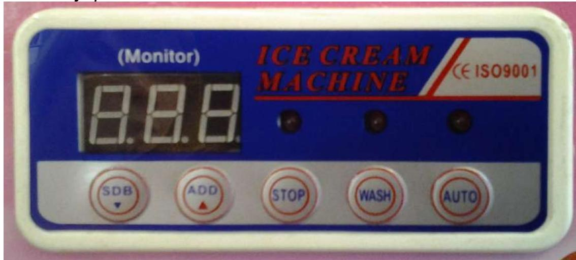
После подключения к сети питания и включения тумблера под панелью управления фризер готов к работе.
