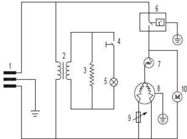
1. Кабель питания; 2. Трансформатор; 3. Нагревательный элемент; 4. Выключатель; 5. LED-индикация; 6. Термостат; 7. Реле защиты; 8. Компрессор; 9. Стартер; 10. Вентилятор
