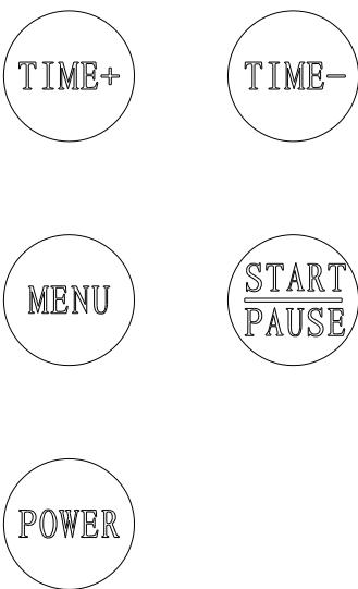
**[POWER«ВКЛ/ВЫКЛ» ]:** После подключения фризера к электросети, аппарат перейдет в режим ожидания и на дисплее появиться «60:00». Нажмите кнопку [POWER], чтобы перейти к выбору настроек. Если Вы нажмете кнопку [POWER] во время работы фризера, то он выключится.
