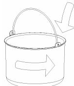
**Шаг 3.** Установите съемную чашу в устройство и слегка нажав, поверните её до плотной посадки в фиксированной чаше.
